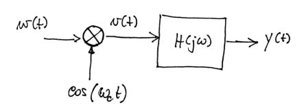
$v(t) = X_1(t) \cos^2(\omega_c t) + X_2(t) \sin(\omega_c t) \cos(\omega_c t) =$   $= \frac{1}{2} X_1(t) \left[ 1 + \cos(2\omega_c t) \right] + \frac{1}{2} X_2(t) \sin(2\omega_c t) =$   $= \frac{1}{2} X_1(t) + \frac{1}{2} X_1(t) \cos(2\omega_c t) + \frac{1}{2} X_2(t) \sin(2\omega_c t)$
